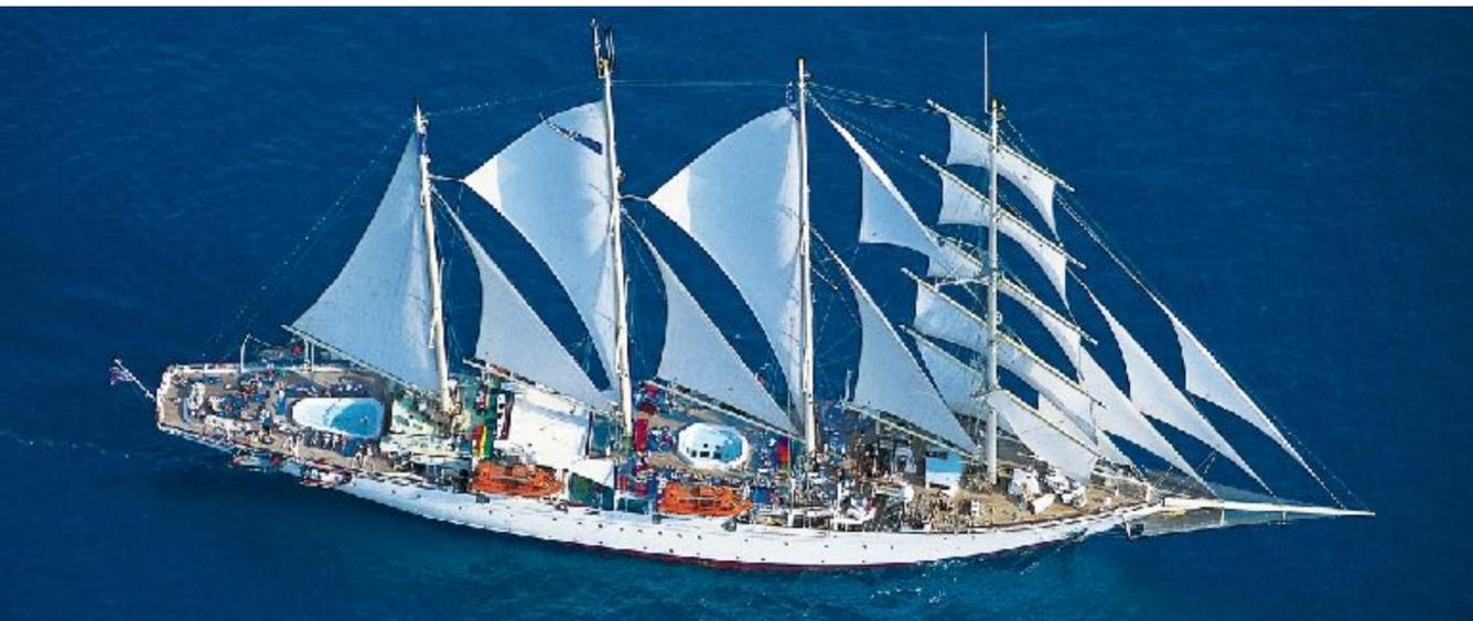
Die »Star Clipper«: Mit ihren 115,5 Metern Länge ist die »Star Clipper« eines der größten Segelschiffe der Welt. Der weiße Großsegler mit 4 Masten und 3.365 Quadratmetern Segelfläche bietet Platz für maximal 166 Gäste und 74 Crewmitglieder.
